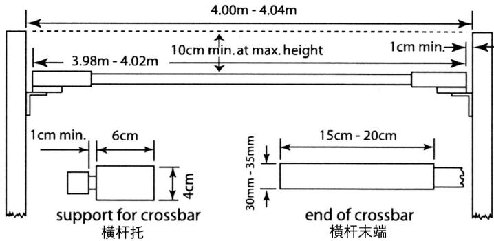
(圖 6 - 立柱、橫杆、橫杆托及杆之末端)
