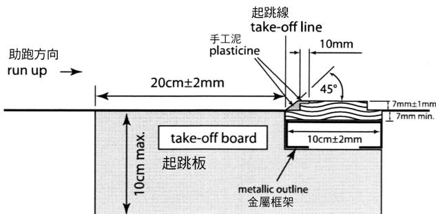
(圖 10 - 起跳板和橡皮泥顯示板)
